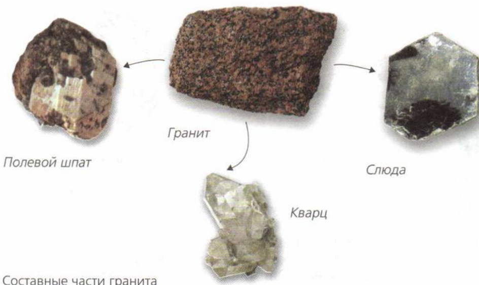
Составные части гранита
